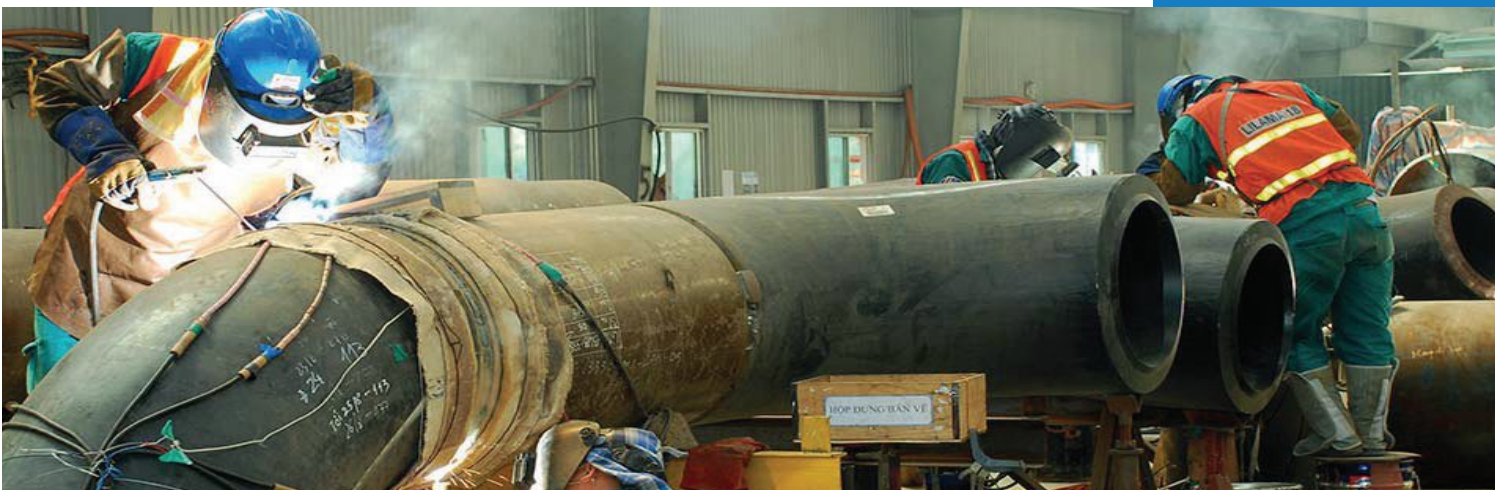
Chế tạo ống áp lực cho nhà máy nhiệt điện Fabrication of pressure piping for thermal power plants
