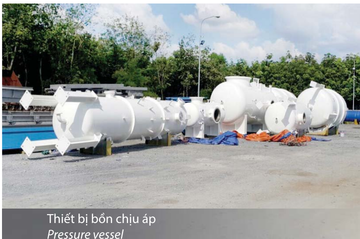
Bồn chịu áp 350 KPa ở nhiệt độ 100° C (VRU) Pressure vessel
